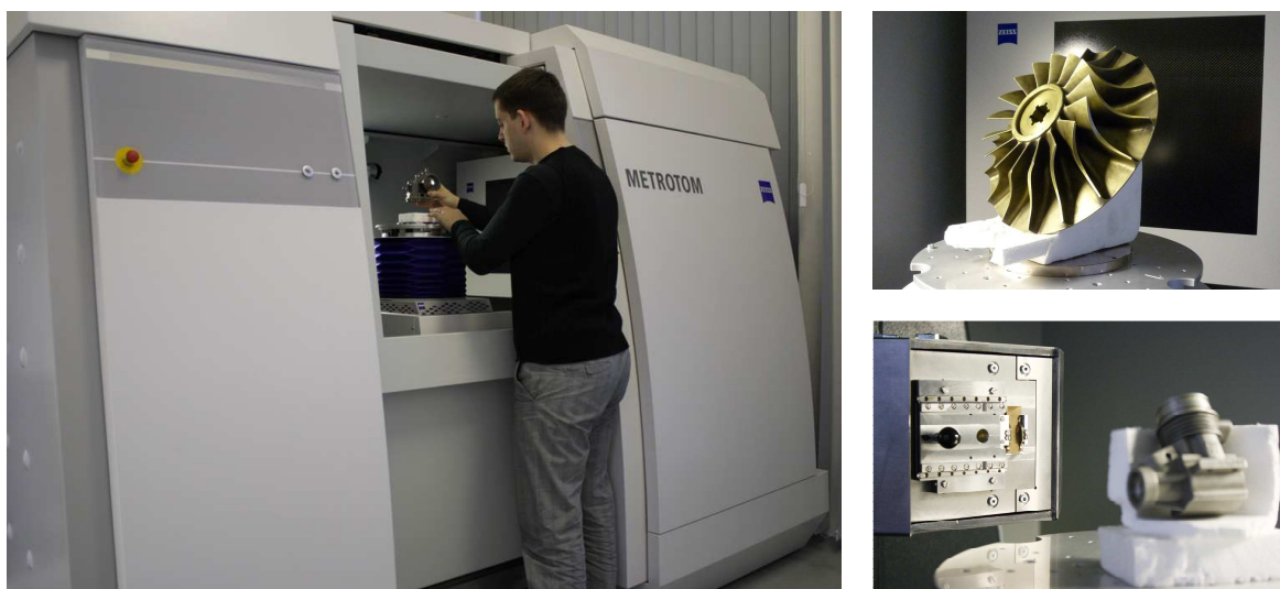
Obr. 2 Metrotom 1500 v Technologickom centre počítačovej tomografie na TU v Košiciach. V pozadí obežného kola vidieť plošný detektor a vedľa karburátora je zdroj rtg žiarenia
