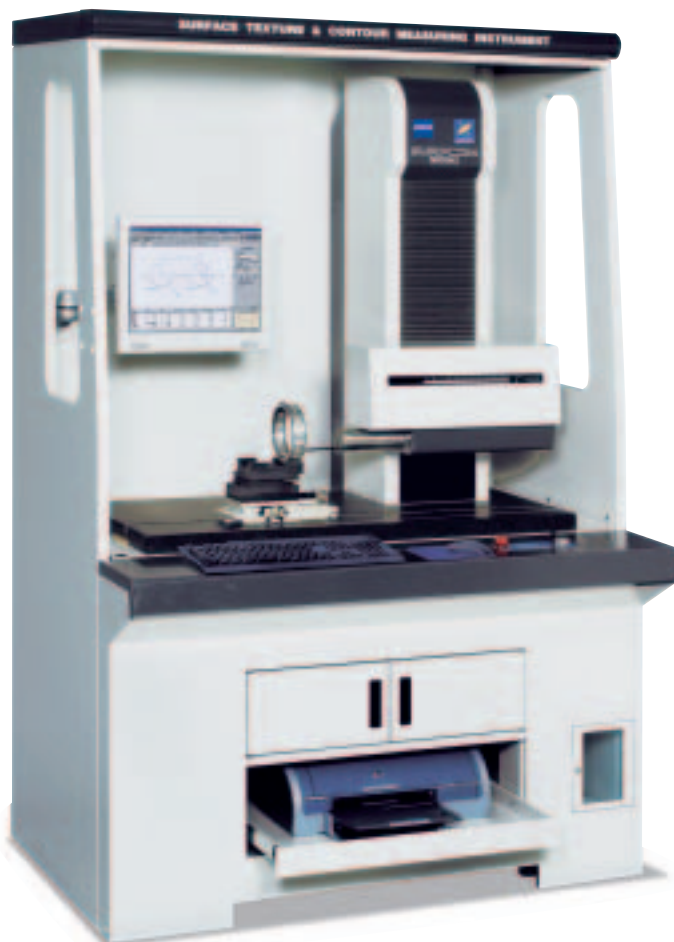
Špičkový přístroj na měření kontur a jakosti povrchu Surfcom 5000
